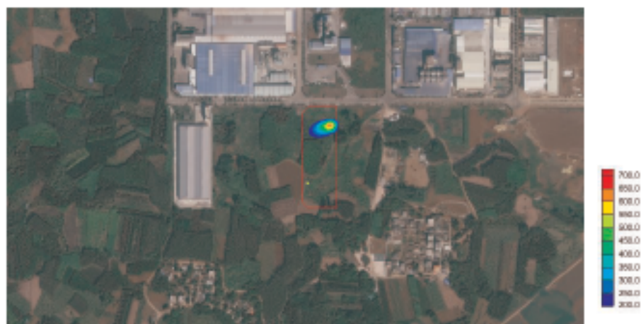
图 5.2-46 泡花碱储罐泄漏发生后 5 年，潜水含水层中钠离子污染晕
