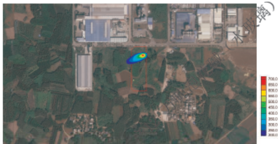
图 5.2-47 泡花碱储罐泄漏发生 10 年，潜水含水层中钠离子污染晕
