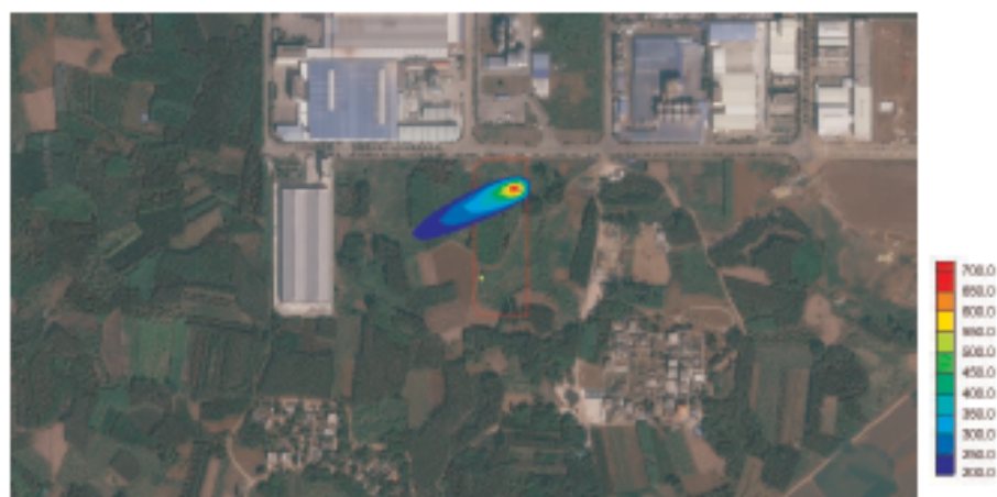
图 5.2-49 泡花碱储罐泄漏发生后 20 年，潜水含水层中钠离子污染晕
