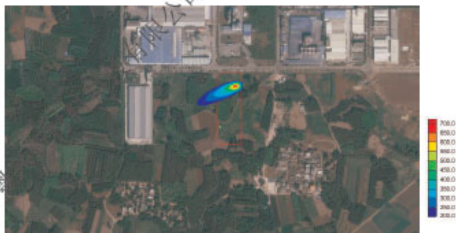
图 5.2-48 泡花碱储罐泄漏发生后 15 年，潜水含水层中钠离子污染晕
