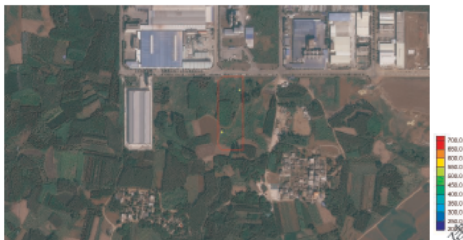
图 5.2-43 泡花碱储罐泄漏发生后 100 天，潜水含水层中钠离子污染晕
