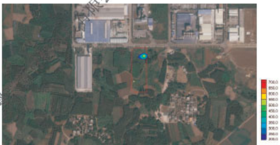
图 5.2-45 泡花碱储罐泄漏发生后 1000 天，潜水含水层中钠离子污染晕
